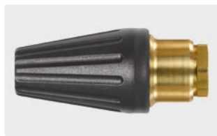
1/4" F. Spray angle 20°. 120 - 250 bar. Max. 100 °C
