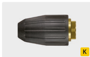
M18 F. Spray angle 20°. 200 - 350 bar. Max. 100 °C
