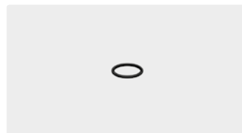
O-ring. TYP SP-20. 13.1x2.6. Max. 150 bar / 100 °C
