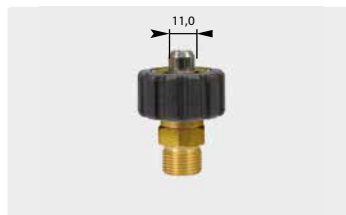
1/2" F : M. Max. 300 bar / 150 °C
