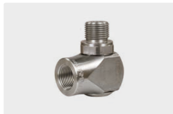
3/8" F : 3/8" M. Max. 400 bar / 30 r.p.m. / 90 °C
