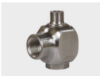
1/2" F : 3/8" M. DN 10. Max. 300 bar / 30 r.p.m. / 90 °C
