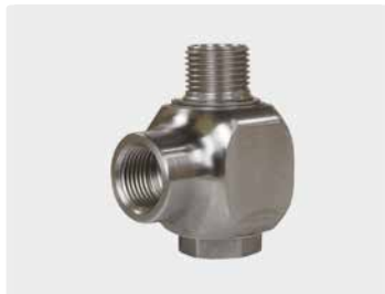
1/2" F : 1/2" M. DN 12. Max. 300 bar / 30 r.p.m. / 90 °C
