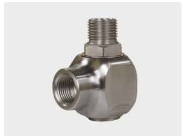
1/2" F : 1/2" M. DN 12. Max. 300 bar / 30 r.p.m. / 90 °C
