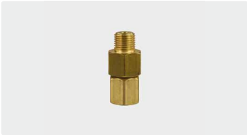
1/4" M : 1/4" F. Brass. Max. 275 bar / 90 °C
