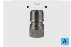
Stecknippel : IG. Edelstahl gehärtet. Max. 250 bar / 150 °C
