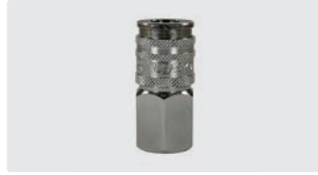
Kupplung : IG. Messing/Stahl, vernickelt. Max. 200 bar / 100 °C
