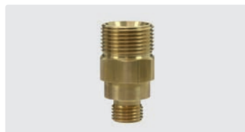
M22 AG : AG. Messing. Langbohrung. Max. 400 bar
