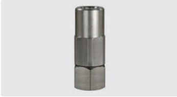
1/4" IG : 3/8" IG. Edelstahl. Drehgelenk mit Radialgleitlager. Max. 350 bar / 90 °C
