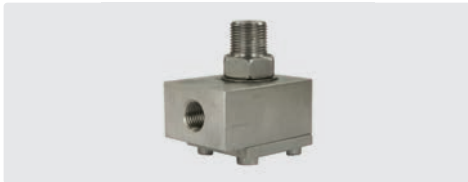
1/4" IG : 3/8" AG. DN 6. Gehäuse und Achse Edelstahl. Max. 600 bar / 90 °C
