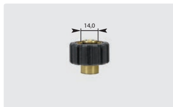
Kurz M22 : IG. Schwarz. Max. 400 bar / 150 °C
