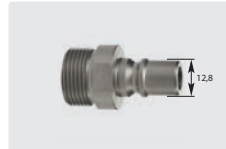
Stecknippel : AG. Edelstahl. Max. 350 bar / 100 °C
