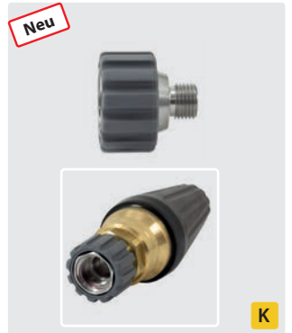
TR20 IG : 1/4" AG. Edelstahl. Max. 400 bar / 150° C
