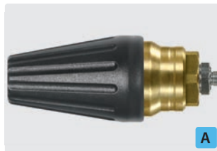
1/8" AG. Spritzwinkel 20°. 200 - 400 bar. Max. 100 °C
