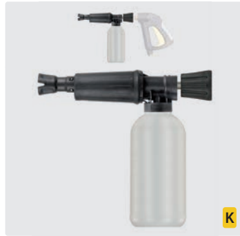
HV M22 drehbar. Schauminjektorlanze mit Dosierung und Flasche. Max. 300 bar / 80 °C
