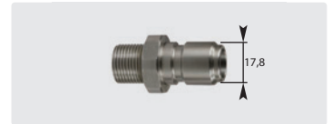
Stecknippel : AG. Edelstahl. 60° Dicht- konus. Max. 250 bar / 150 °C
