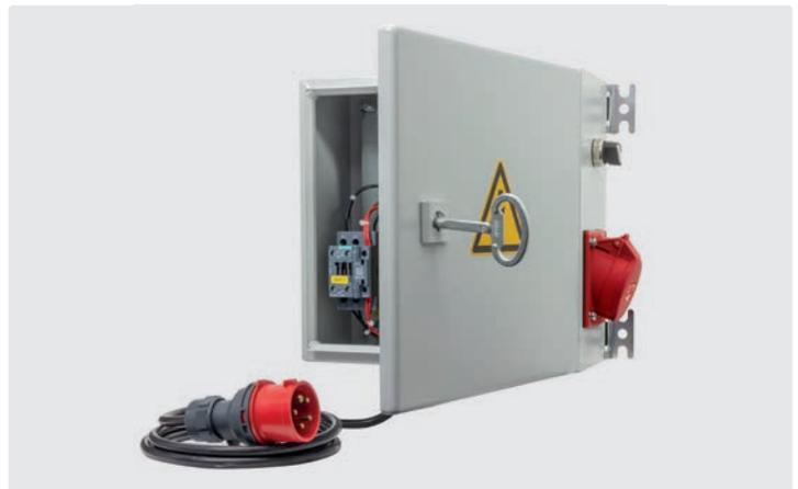
Steuerkasten, IP 66, RAL 7035. H x B x T 300 x 300 x 155 mm. Mit Einspeisung 2 m Leitung mit CEE-Stecker, 16 A, 400 V AC, 50 HZ, 3 Ph/N/PE. Steuerspannungsaufbereitung 24 V AC, 20 VA mit 2 Sicherungsautomaten.
