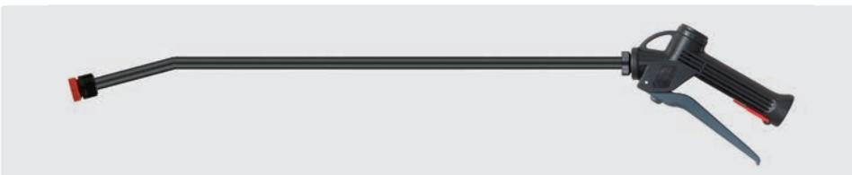
600 mm. Chemiepistole mit Lanze aus Kunststoff und Düsenhalter ohne Düse. Pistole mit chemiebeständiger Edelstahlkugel V4A / AISI 316. Max. 25 bar / 30 l/min / 50 °C
