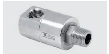
**DGE 90°.** Gehäuse Messing vernickelt. 1-fach kugelgelagert. Max. 275 bar
