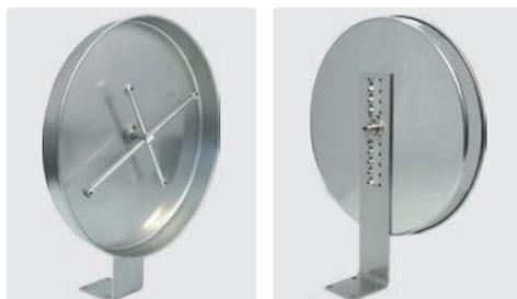
Poliertes Edelstahl. Zubehör für automatische Waschanlagen. Schnellläufer Drehgelenk. Rotorarm wird durch Wasser angetrieben. Höhenverstellbar. Anschluss über einen Schlauch des Pumpensystems. Es werden 4 Düsen mit 1/8" AG NPT benötigt.
