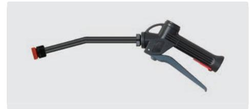
210 mm. Chemiepistole mit Lanze aus Kunststoff und Düsenhalter ohne Düse. Pistole mit chemiebeständiger Edelstahlkugel V4A / AISI 316. Max. 25 bar / 30 l/min / 50 °C
