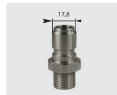
Stecknippel : AG. Edelstahl. 60° Dichtkonus. Max. 250 bar / 150 °C
