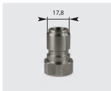
Stecknippel : IG. Edelstahl. Max. 250 bar / 150 °C
