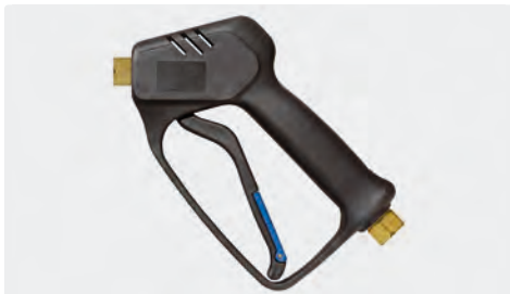
Professionelle Pistole. Weepausführung. Max. 210 bar / 25 l/min / 150 °C
