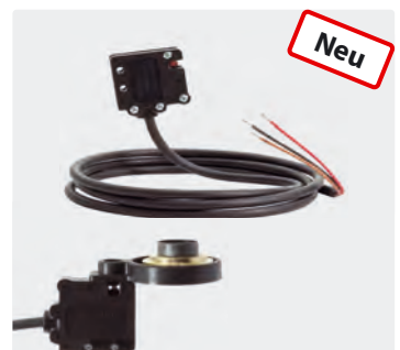
Schalter für Suttner Umlaufventil ST-265. Schutzklasse IP65. Kabel 1.200 mm, 3xAWG20. Max. Einschaltstrom 10mA-5A(2A). Volt: 12-24VDC, 12-250VAC
