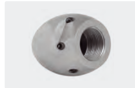
3/4" IG. 6x 75° +1x 0°. 30-100 l/min. Für \text{R} \text{Ø} 120-250 mm. Außen \text{Ø} 50 mm. \text{G} 567 g.
