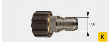
Stecknippel : IG. Edelstahl + Messing. Max. 250 bar / 150 °C
