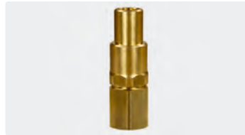
1/4" IG : 1/2" IG. Messing. Max. 250 bar / 90 °C
