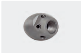
1/4" IG. 6x 75° +1x 0°. 20-50 l/min. Für \text{R} \text{Ø} 50-100 mm. Außen \text{Ø} 30 mm. \text{G} 127 g.
