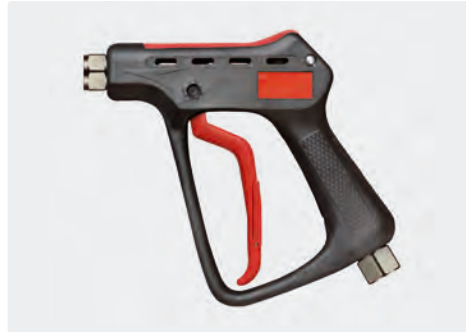
Professionelle Höchstdruckpistole. Max. 600 bar / 80 l/min / 150 °C
