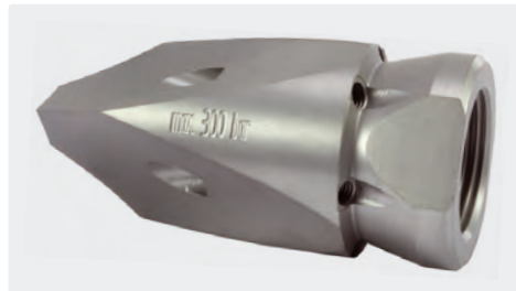
300 bar. 3/4" IG. \square 80 mm, \varnothing = 38 mm, \boxtimes 0,29 kg. Für Rohre > 80 mm. Seitliche Frontstrahlen mit gehärteten Edelstahl Düseneinsätzen.
