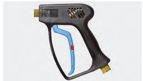
Professionelle Pistole. Frostschutzausführung. Max. 275 bar / 45 l/min / 150 °C
