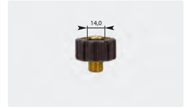
Kurz M22 : AG. Schwarz. Max. 400 bar / 150 °C
