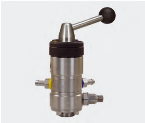
3/8" IG : 1/2" IG : 2 x Tülle 9 mm : Druckluftmodul (1/4" AG). Regulierung der Chemiedosierung erfolgt durch 2 x 10 auswechselbare Dosier- einsetze (0,5 - 2,0 mm). Max. 350 bar / 100 °C
