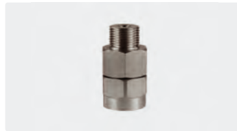
3/8" AG : 3/8" IG. Edelstahl. Max. 500 bar / 90 °C
