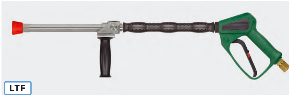
1/2" IG. Edelstahl. Weitwurflanze 350 mm mit Isolierung ST-29 Cool & Compact 330 mm, Pistole easyfarm365+, seitlichem Handgriff und Düsenschutz aus Kunststoff ohne Düse. Max. 250 bar / 60 l/min / 100 °C
