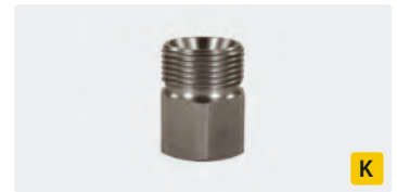
M22 AG : IG. Edelstahl. Max. 500 bar
