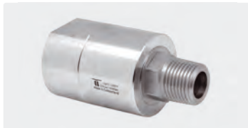
DGE. Gehäuse Messing vernickelt. 1-fach kugelgelagert. Max. 275 bar
