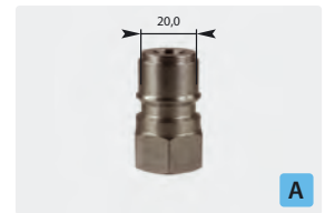
Stecknippel : IG. Edelstahl gehärtet. Max. 250 bar / 150 °C
