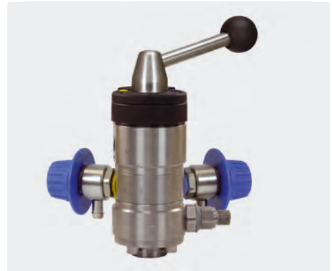
3/8" IG : 1/2" IG : 2 x Tülle 9 mm : Druckluftmodul (1/4" AG). Regulierung der Chemiedosierung erfolgt durch das Dosier-ventil ST-161. Max. 350 bar / 100 °C
