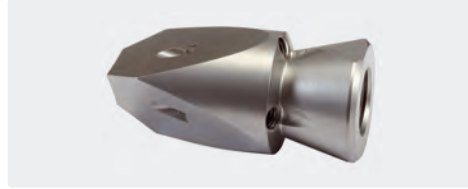
300 bar. 1/4" IG. \square 50 mm, \varnothing = 25 mm, \boxtimes 0,13 kg. Für Rohre > 30 mm. Seitliche Frontstrahlen 0,5 mm gebohrt.
