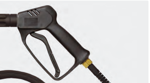
Professionelle Pistole mit Verlängerung 340 mm, max. 210 bar / 25 l/min / 150 °C. Eingang / Ausgang HV M22. Schlauch: Flexy mit 1 Drahteinlage, max. 300 bar / 100 °C
