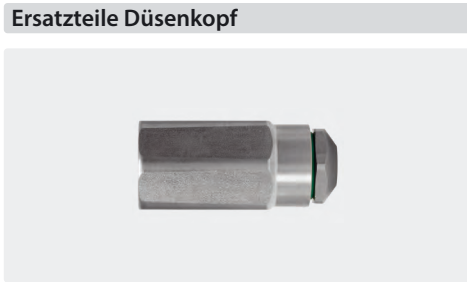
3/8" IG : 1/4" IG. Edelstahl. Düsenkopf ohne Düse
