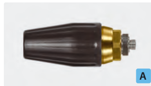
1/8" AG. Spritzwinkel 20°. 100 - 250 bar. Max. 100 °C
