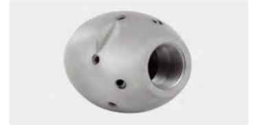
3/4" IG. 6x 75° 3x 30° +1x 0°. 100-250 l/min. Für \text{R} \text{Ø} 150-300 mm. Außen \text{Ø} 50 mm. \text{G} 1.367 g.
