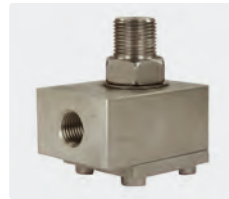
1/4" IG : 3/8" AG. Achse und Gehäuse Edelstahl. Max. 600 bar / 90 °C
