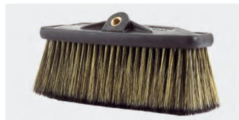
A= 270. B= 260 x 80 mm. Schweineborsten / Synthetik. Max. 40 l/min / 60 °C
