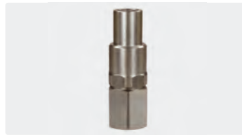
1/4" IG : 1/2" IG. Edelstahl. Max. 350 bar / 90 °C
