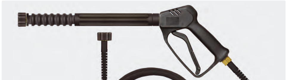
Pistole mit Verlängerung 340 mm, max. 210 bar / 25 l/min / 150 °C. Eingang / Ausgang HV M22. Schlauch: 6 - 160 mit 1 Gewebeeinlage, max. 160 bar / 20 °C
