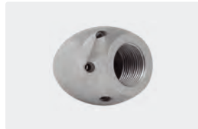
1/2" IG. 6x 75° +1x 0°. 30-100 l/min. Für \text{R} \text{Ø} 100-200 mm. Außen \text{Ø} 40 mm. \text{G} 281 g.
