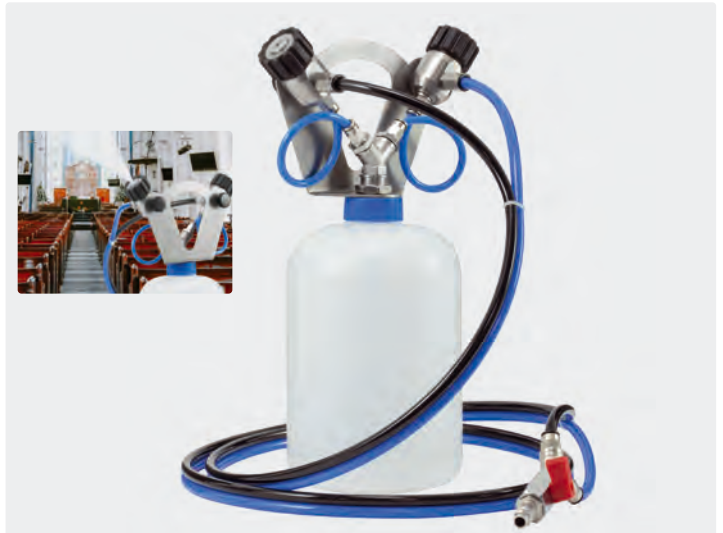
Desinfektions-Kalt-Nebelgerät ST-83.2. Für Druckluftanschluss 3 bar, 200-400 l/min. Edelstahl/PVC
