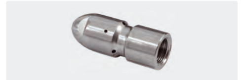
M7x0,5 IG. Bohrungen nach hinten für optimalen Vortrieb. Zusätzlich 3 seitliche Bohrungen (90°) für hohe Aufprallkräfte und optimale Wandabdeckung. Außen \varnothing 9,8 mm. Edelstahl. Max. 500 bar
