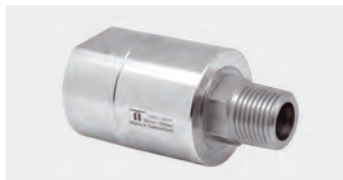
DGEI. Gehäuse Edelstahl. 3-fach gelagert. Max. 350 bar
