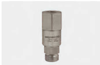
1/4" IG : M18 AG. Max. 275 bar / 120 °C
