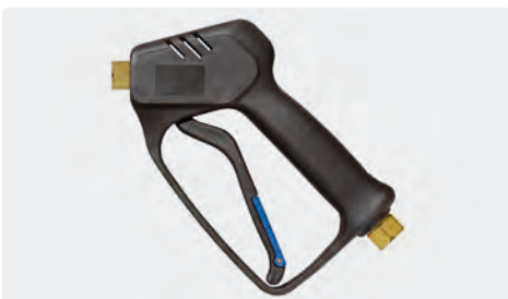
Professionelle Pistole. Weepausführung. Max. 210 bar / 25 l/min / 150 °C
