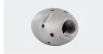
1/2" IG. 6x 75° 3x 30° +1x 0°. 80-140 l/min. Für \text{R} \text{Ø} 120-250 mm. Außen \text{Ø} 40 mm. \text{G} 630 g.
