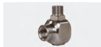
1/2" IG : 1/2" AG. DN 12. Max. 30 U/min / 90 °C
