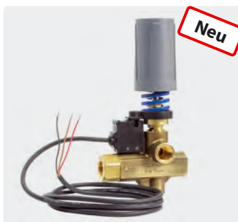
☉ = Eingang 3/8" IG. ☉ = Ausgang 3/8" IG. [BP] = Bypass 3/8" IG. Kugel-Rückschlagventil. Umlaufventil mit Schalter (IP65) und Kabel 1.200 mm. Max. 350 bar / 80 °C
