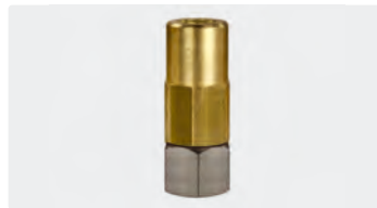
1/4" IG : 3/8" IG. Edelstahl / Messing. Drehgelenk mit Radialgleitlager. Max. 350 bar / 90 °C
