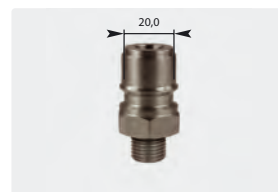
Stecknippel : AG. Edelstahl gehärtet. Max. 250 bar / 150 °C
