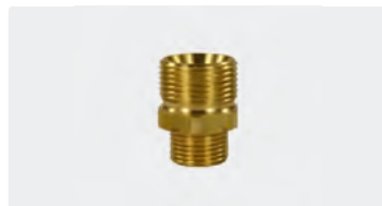
M22 AG : AG. Messing. Max. 400 bar
