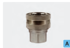
Kupplung : IG. Messing vernickelt. Max. 250 bar / 150 °C
