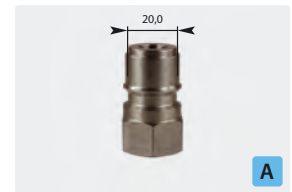
Stecknippel : IG. Edelstahl gehärtet. Max. 250 bar / 150 °C
