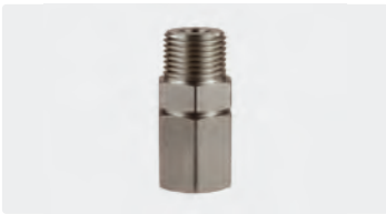
1/2" AG : 1/2" IG. Edelstahl. Max. 350 bar / 90 °C
