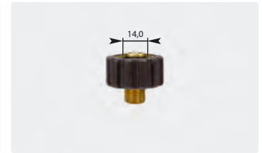
Kurz M22 : AG. Schwarz. Max. 400 bar / 150 °C
