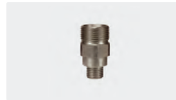
M22 AG : 1/4" AG. Langbohrung. Max. 400 bar / 150 °C
