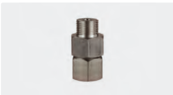
3/8" AG : 3/8" IG. Edelstahl. Max. 350 bar / 90 °C
