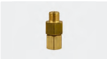
1/4" AG : 1/4" IG. Messing. Max. 275 bar / 90 °C
