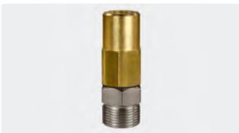
1/4" IG : M22 AG. Edelstahl / Messing. Drehgelenk mit Radialgleitlager. Max. 350 bar / 90 °C
