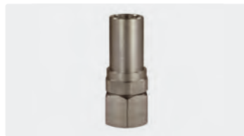
1/4" IG : 3/8" IG. Edelstahl. Max. 350 bar / 90 °C
