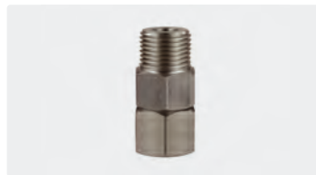
1/2" AG : 1/2" IG. Edelstahl. Max. 350 bar / 90 °C
