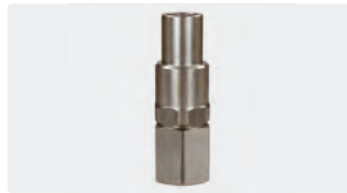
1/4" IG : 1/2" IG. Edelstahl. Max. 350 bar / 90 °C
