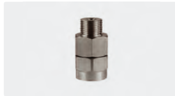
3/8" AG : 3/8" IG. Edelstahl. Max. 500 bar / 90 °C
