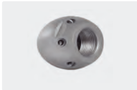
3/8" IG. 6x 75° +1x 0°. 25-70 l/min. Für \text{R} \text{Ø} 75-150 mm. Außen \text{Ø} 35 mm. \text{Ø} 207 g.
