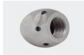
3/4" IG. 6x 75° +1x 0°. 30-100 l/min. Für \text{R} \text{Ø} 120-250 mm. Außen \text{Ø} 50 mm. \text{Ø} 567 g.
