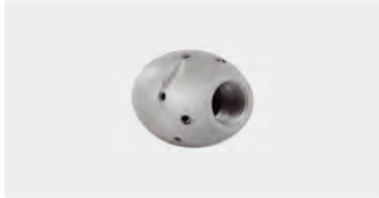
1/4" IG. 6x 75° 3x 30° +1x 0°. 25-70 l/min. Für \text{R} \text{Ø} 75-150 mm. Außen \text{Ø} 30 mm. \text{Ø} 223 g.
