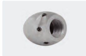
1/2" IG. 6x 75° +1x 0°. 30-100 l/min. Für \text{R} \text{Ø} 100-200 mm. Außen \text{Ø} 40 mm. \text{Ø} 281 g.
