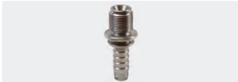
Pressnippel. M7x0,5 AG. DN 4. Edelstahl. Max. 500 bar
