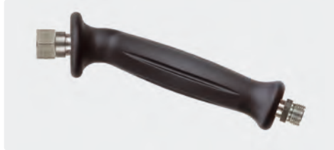
Edelstahl. Handgriff 20° abgewinkelt. Max. 350 bar / 150 °C
