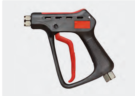
Professionelle Höchstdruckpistole. Max. 600 bar / 80 l/min / 150 °C
