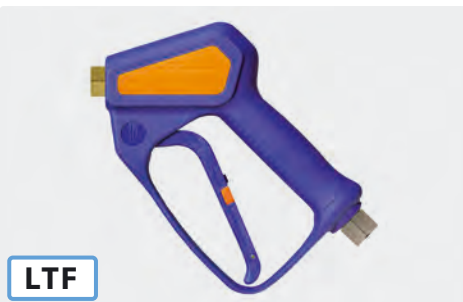
Professionelle Pistole. Weepausführung. Max. 310 bar / 45 l/min / 150 °C
