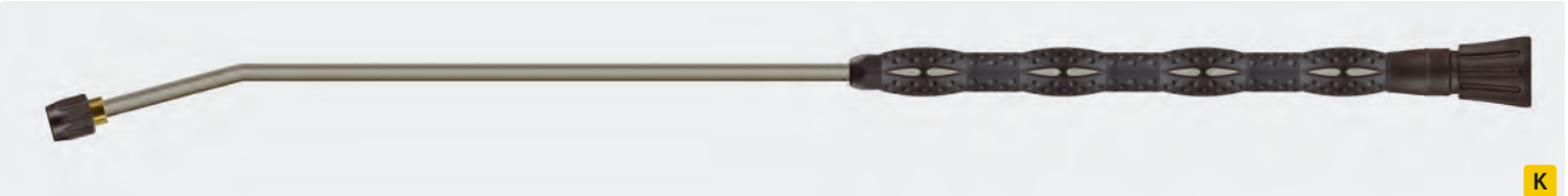
HV M22 drehbar. Strahlrohr mit Isolierung ST-22 und Düsenschutz ohne Mundstück. Max. 400 bar / 150 °C
