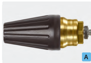
1/8" AG. Spritzwinkel 20°. 200 - 400 bar. Max. 100 °C
