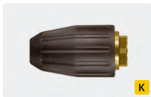
M18 IG. Spritzwinkel 20°. 200 - 350 bar. Max. 100 °C
