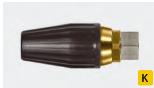
M18 IG. Spritzwinkel 20°. 100 - 250 bar. Max. 100 °C
