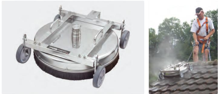
Komplett Edelstahl. Reiniger mit zusätzlichem Rahmen für höchste Stabilität. Höhen- und Breitenverstellung: max. 33 mm (Höhe) und 90 mm (Breite). Es werden 2 Düsen benötigt. Inklusive einer Sicherheitsöse zur Befestigung des Sicherungsseils mit Karabinerhaken. Wir empfehlen die Nutzung der Fußbetätigung ST-550. 4 Industrierollen (125 mm).
