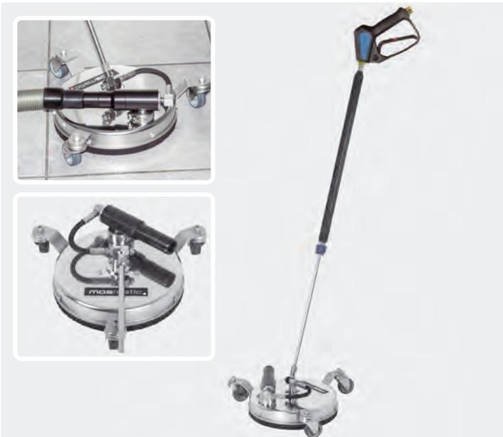
Flächenreiniger AQUA mit Absaugung. Komplett mit integrierter Selbstabsaugung, inklusive Pistole und Düsen. Absaugung: 40 mm. Ausgelegt auf 150 bar / 15 l/min. Die schwarz eloxierte Absaugung aus Alu, saugt das Schmutzwasser durch das Venturi Prinzip und über das Doppelgehäuse System auf. Es kann dann über einen handelsüblichen Absaugschlauch weggeführt werden. Es ist kein zusätzlicher Industriesauger nötig.
