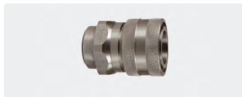
Kupplung : IG. Edelstahl. Max. 250 bar / 150 °C
