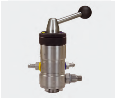
3/8" IG : 1/2" IG : 2 x Tülle 9 mm : Druckluftmodul (1/4" AG). Regulierung der Chemiedosierung erfolgt durch 2 x 10 auswechselbare Dosiereinsätze (0,5 - 2,0 mm). Max. 350 bar / 100 °C
