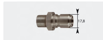
Stecknippel : AG. Edelstahl. 60° Dicht- konus. Max. 250 bar / 150 °C
