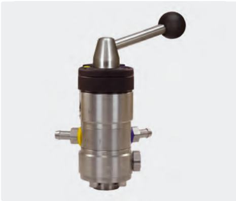
3/8" IG : 1/2" IG : 2 x Tülle 9 mm. Regulierung der Chemiedosierung erfolgt durch 2 x 10 auswechselbare Dosiereinsätze (0,5 - 2,0 mm). Max. 350 bar / 100 °C
