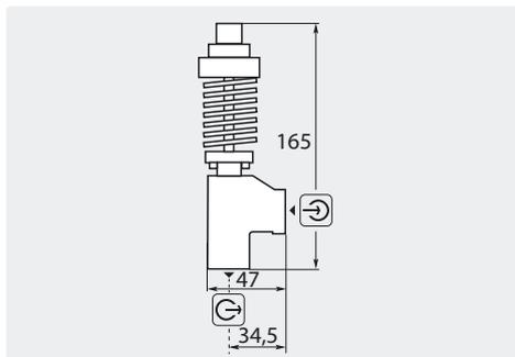
☉ 165 mm. Max. 40 l/min / 60 °C. Kurzfristig max. 85 °C
