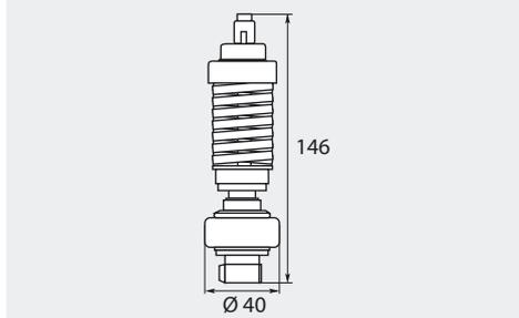
☉ 146 mm. Max. 700 bar / 50 l/min / 85 °C
