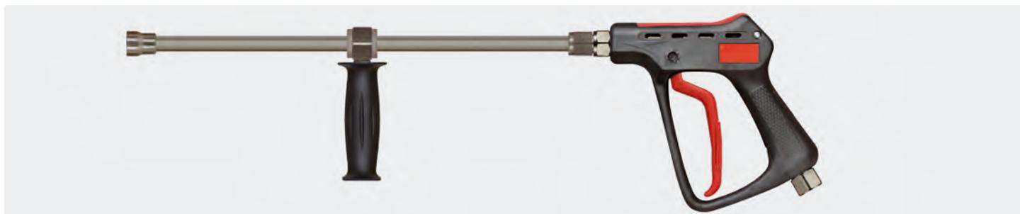
Professionelle Höchstdruckpistole mit Strahlrohr 500 mm mit Handgriff und Muffe 1/4" IG NPT aus Edelstahl ohne Hochdruckdüse. Max. 600 bar / 150 °C
