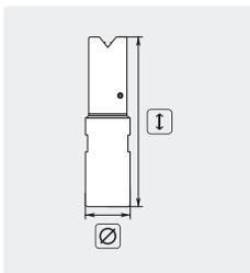
1/8" IG. Seitenstrahl 2. Vorstrahl 2. Rostfreier Edelstahl. Rotationskörper Hochdruckbronze. Kompakte Bauform, universell einsetzbar. Extrem hohe Reinigungsleistung, entfernt härteste Ablagerungen.  $\updownarrow$  80 mm.  $\varnothing$  12 mm. Gewicht 0,18 kg. Max. 1.000 bar
