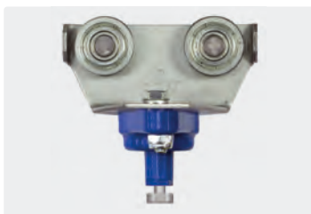
Für Profil 32 x 30 mm. Tragfähigkeit 20 kg. Laufrollen kugellagert. - 30 °C - + 60 °C
