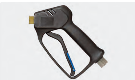
Professionelle Pistole. Weepausführung. Max. 210 bar / 25 l/min / 150 °C
