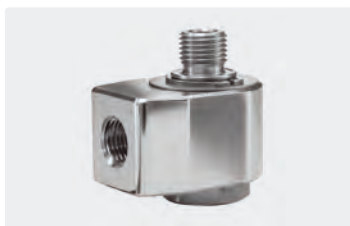
1/4" IG : 1/4" AG. DN 7. Max. 150 bar / 30 U/min / 90 °C
