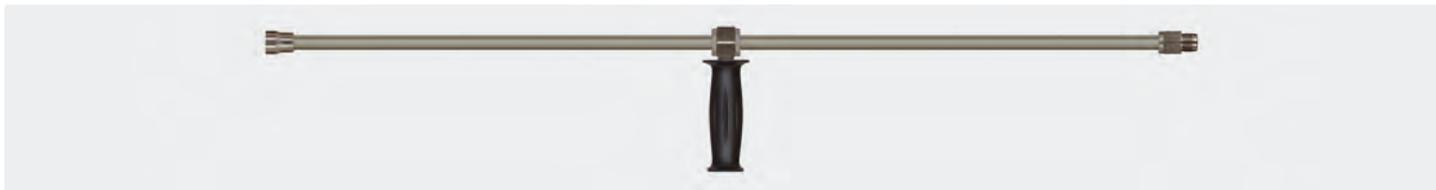
1/2" AG. Strahlrohr mit Handgriff und Muffe 1/4" IG NPT aus Edelstahl ohne Hochdruckdüse. Max. 600 bar / 150 °C
