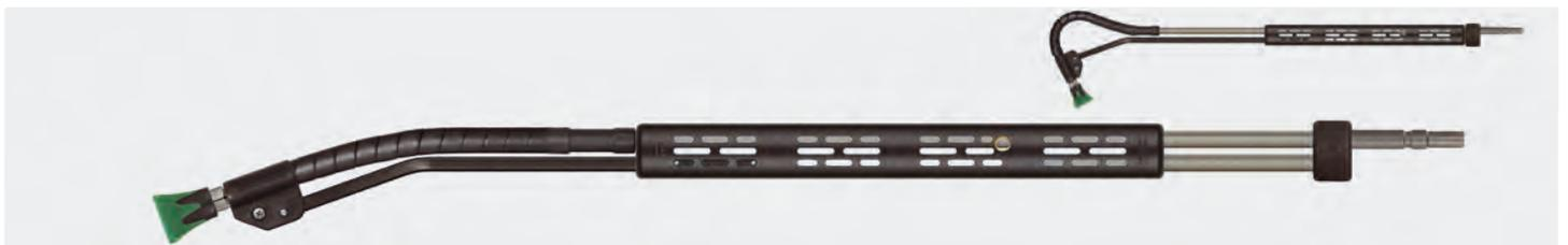
Stecknippel KW. Strahlrohr aus Edelstahl, Isolierung ST-9 380 mm und Düsenschutz ST-10 ohne Düse. Stufenlose Verstellung des Biegewinkels der Lanze von 20 - 140°. Sie erreichen jeden Winkel ohne Verrenkungen und mühelos. Max. 210 bar / 150 °C
