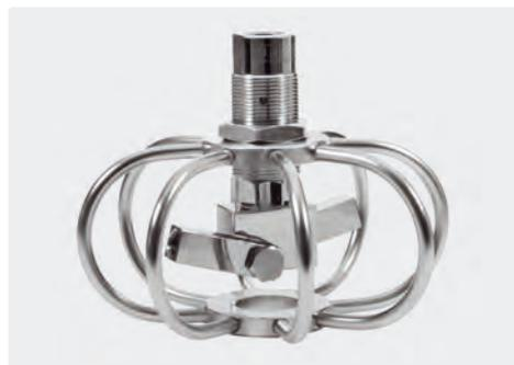
TYR-2s einstellbar. Rohrreiniger mit einstellbaren Rotorarmen für variable Sprühwinkel. Komplett rostfrei. Eingang 3/8" IG. Lieferung erfolgt ohne Düsen. Es werden 2 Düsen mit 1/8" AG benötigt. Max. 275 bar / 120 °C
