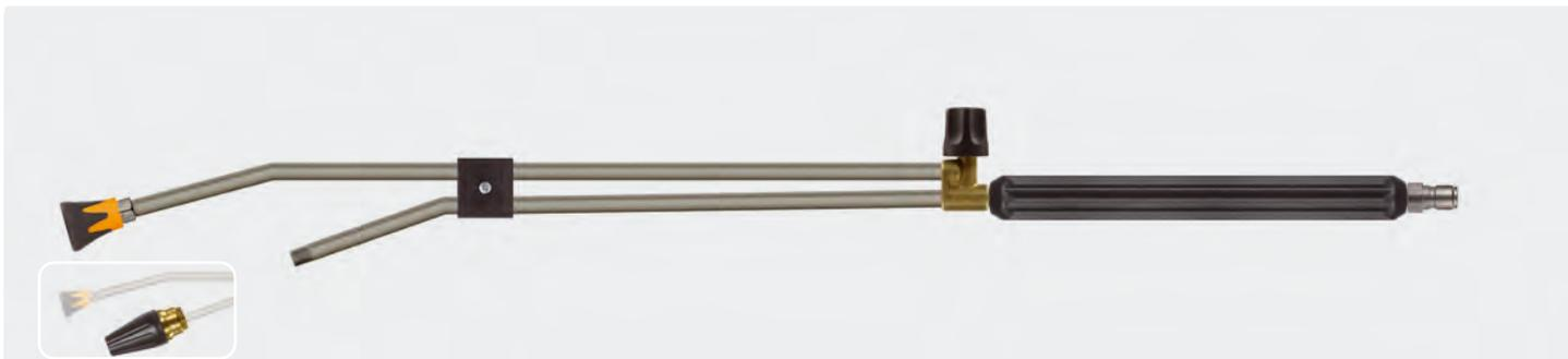
Stecknippel ST-3100. Strahlrohr aus Edelstahl, umspritzte Isolierung 300 mm, Ventil ST-53 oben, Düsenschutz ST-10 mit Niederdruckdüse und 1/4" AG Anschluss für Rotordüsen. Strahlrohre werden ohne Rotordüsen geliefert. Max. 250 bar / 150 °C
