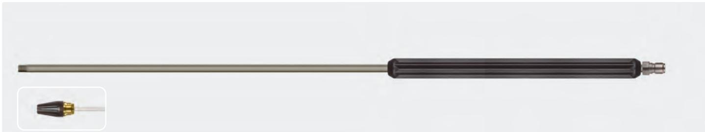
Stecknippel ST-3100. Strahlrohr aus Edelstahl, umspritzte Isolierung 400 mm und 1/4" AG Anschluss für Rotordüsen. Strahlrohre werden ohne Rotordüsen geliefert. Max. 400 bar / 150 °C
