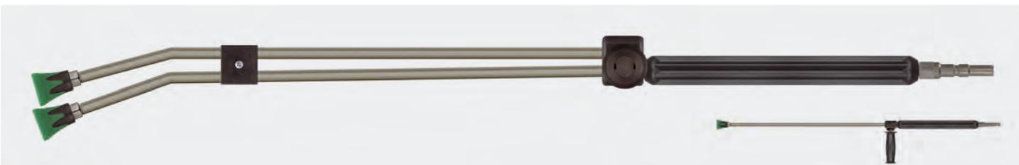
Stecknippel KW. Strahlrohr aus Edelstahl, umspritzte Isolierung 300 mm, Ventil ST-54 seitlich und Düsenschutz ST-10 mit Niederdruckdüse & Muffe 1/4" IG. Max. 310 bar / 150 °C
